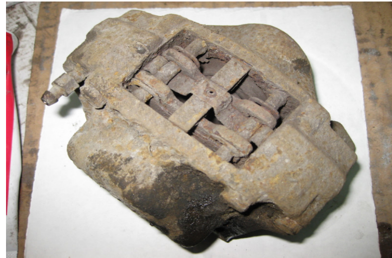
3. Суппорт изношен: отказал один поршень, истерта колодка, порван пыльник, левый суппорт подвергся воздействию реагентов и воды
