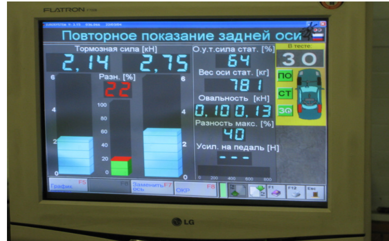
2. Разница тормозных усилий 22 %, при максимально допустимых 20 %
