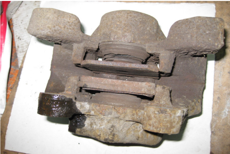
3. Суппорт изношен: отказал один поршень, истерта колодка, порван пыльник, левый суппорт подвергся воздействию реагентов и воды
