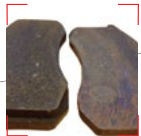
Неравномерный износ колодок
