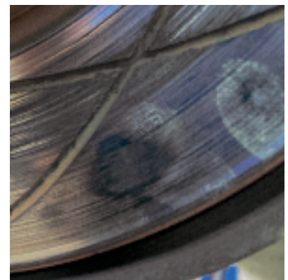
Sobrecalentamiento del disco de freno:
