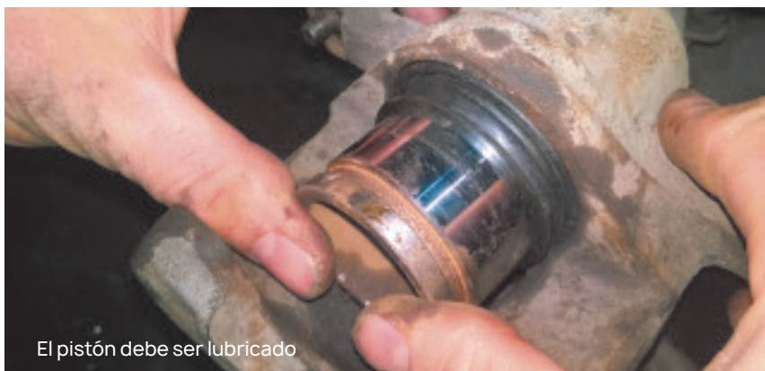
Corrosión, atascamiento del pistón y las guías:
