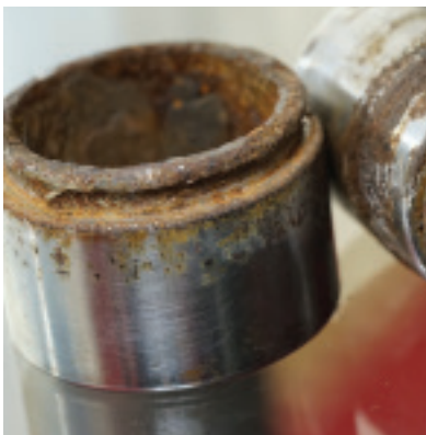
Corrosión, atascamiento del pistón y las guías:
