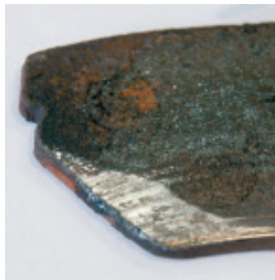
Desalineación, desgaste desigual de las pastillas de freno:
